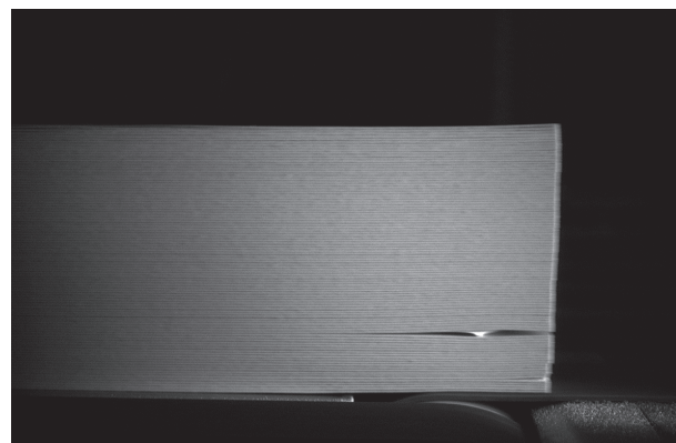
写真5 折れの撮影画像 Photo 5 Captured image of paper folded
